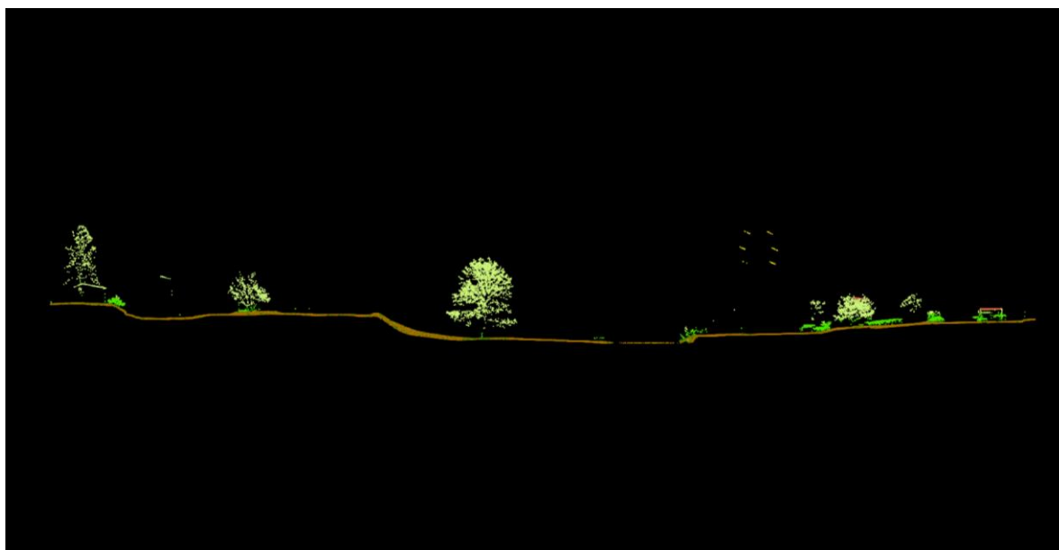
Slika 3: Klasificirani LIDAR podatki v prečnem prerezu (ArcGIS)
