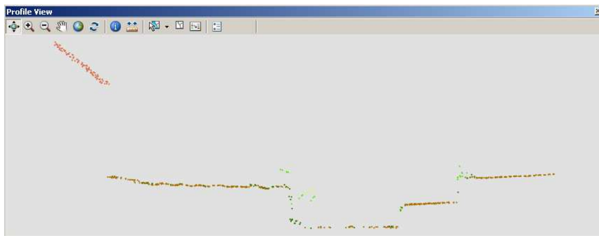
Slika 19: Primer prikaza LIDAR podatkov (vir: Arc-Map)
